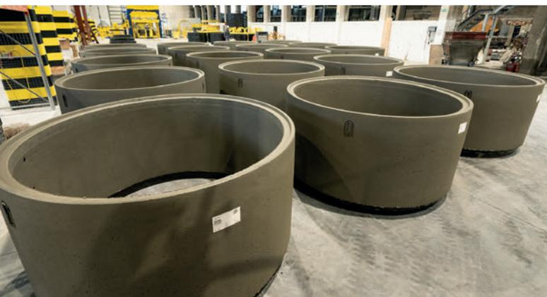
En Sollenau se fabrican diariamente hasta 110 anillos para pozos DN 2000 o 90 anillos para pozos DN 2500 en un solo turno.
