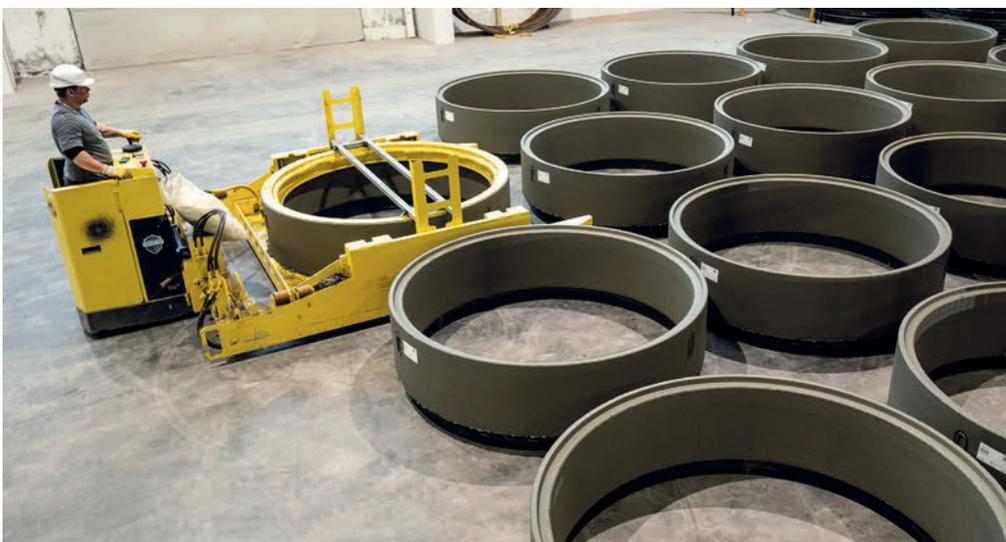
*Los productos recién elaborados se retiran con cuidado a la zona de endurecimiento mediante un carro y un manipulador de anillos de apoyo.*
