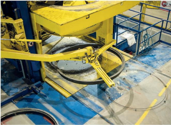
*En cada ciclo de producción, se transfiere de forma automática a la máquina un encofrado inferior de acero.*
