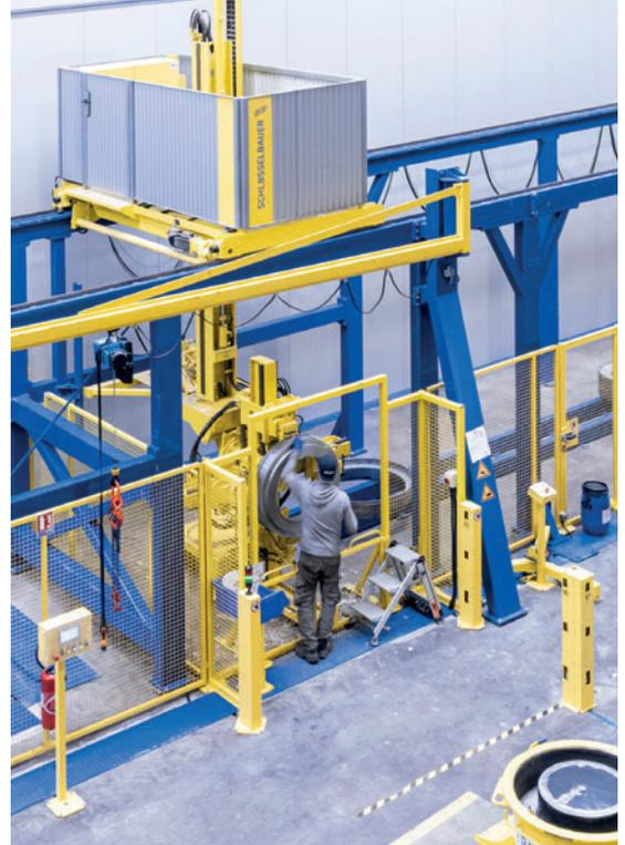
Los manguitos superiores se desplazan de forma automática y se disponen en un puesto de trabajo optimizado ergonómicamente para la limpieza.
