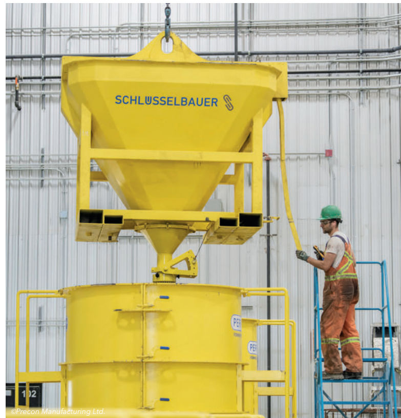
El silo móvil de hormigón se puede manejar con una grúa de nave o una carretilla elevadora.
