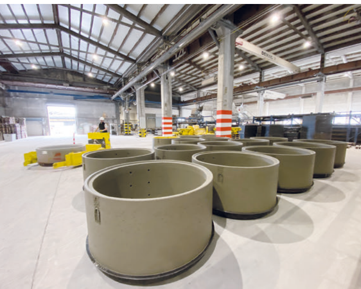
Productos recién elaborados en la zona de endurecimiento de la nave de producción
