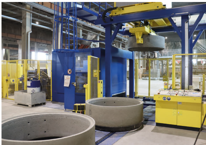
Imagen de la estación de paletizado con la unidad de limpieza azul encerrada colindante y la posterior estación de lubricación de encofrados anulares
