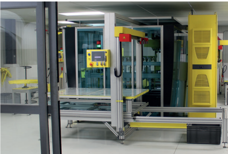
El corazón de la producción de bases de pozos de hormigón Perfect: el centro de corte con sierras de 2D y 3D
