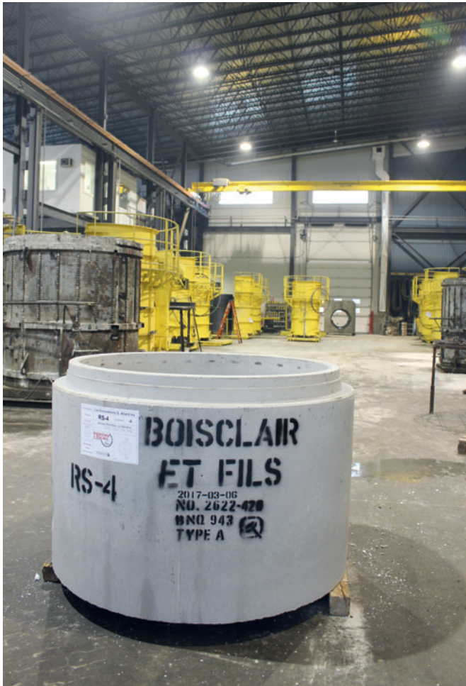
Base de pozo de hormigón Perfect terminada antes de su transporte al almacén exterior
