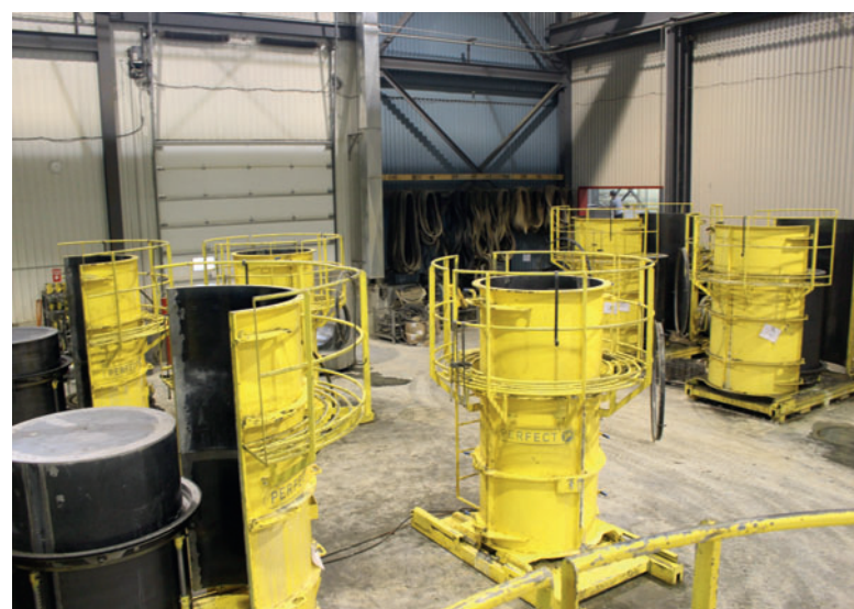
Estación de moldes para la producción de bases de pozos de hormigón Perfect
