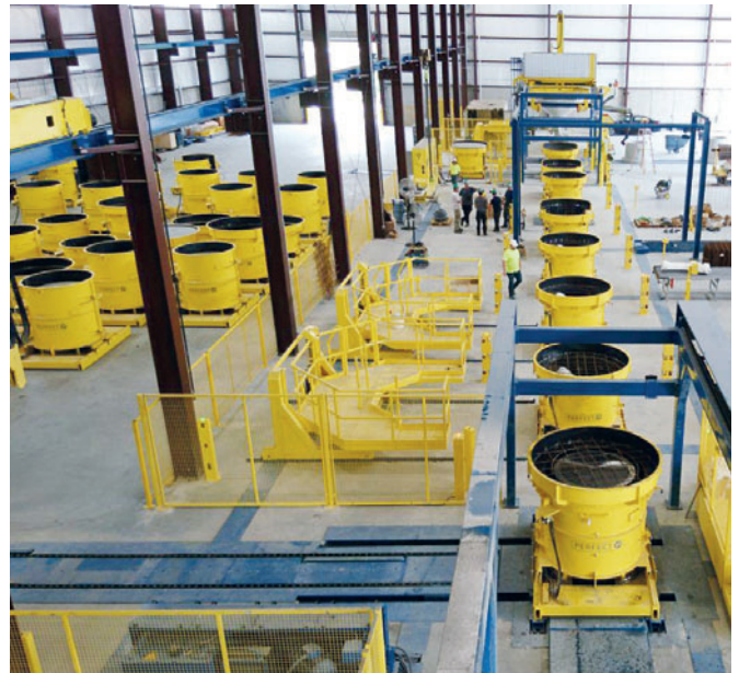
El sistema de producción Perfect Forming Technology de la planta de CP&P en Ashland permite la producción de bases de pozos más eficiente del país
