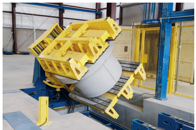
Se ha instalado una estación de giro automático para manipular los productos con protección antielevación
