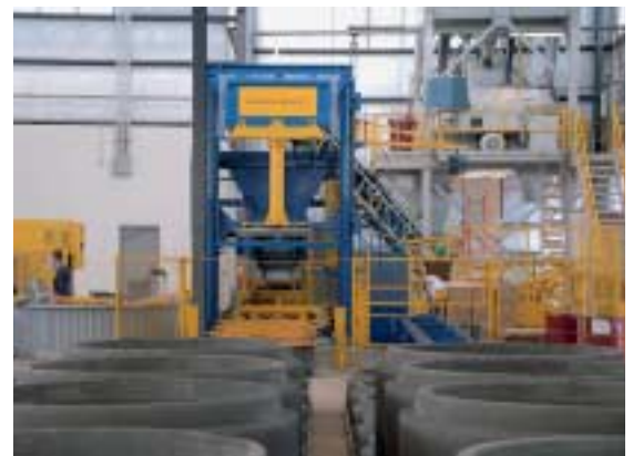
Fig. 3 Production of elements up to nominal 60" inside diameter and up to an effective height of 48". Abb. 3 Produktion von Schachtringen bis 1.500 mm Durchmesser und einer effektiven Höhe von 1.000 mm.
