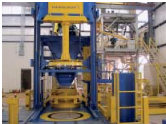
Fig. 1 MAGIC 1500 production plant for manhole components. Abb. 1 Produktionsanlage für Schachtelemente – Magic 1500.
