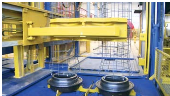
Fig. 5 Manipulación de palés y jaulas totalmente automatizada.
