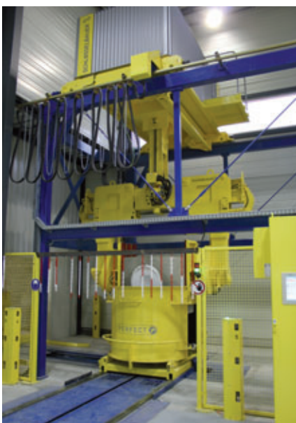
Las bases de pozo endurecidas se retiran del molde abierto con la cuchara de la grúa....
