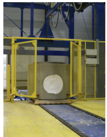
... y se colocan en la cinta transportadora y se transportan a la última estación de procesamiento, donde se retiran los moldes de EPS de las bases de hormigón
