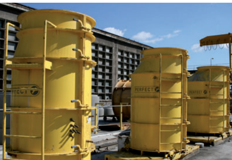
Los tres nuevos moldes para conos de pozos de hormigón de hasta 2.350 mm de altura con anchos nominales de 1.000, 1.200 y 1.500 mm
