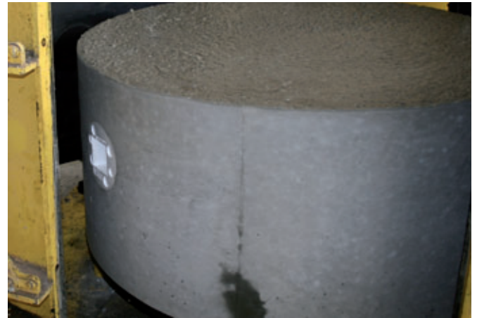
Base de pozo endurecida tras abrir el molde
