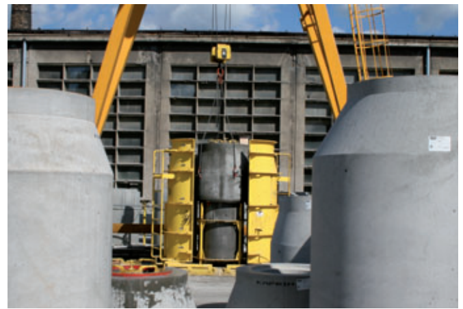
Se deja endurecer el tiempo suficiente y después se vuelven a abrir los moldes y se izan los conos para pozos con la grúa, sacándolos del molde con cuidado
