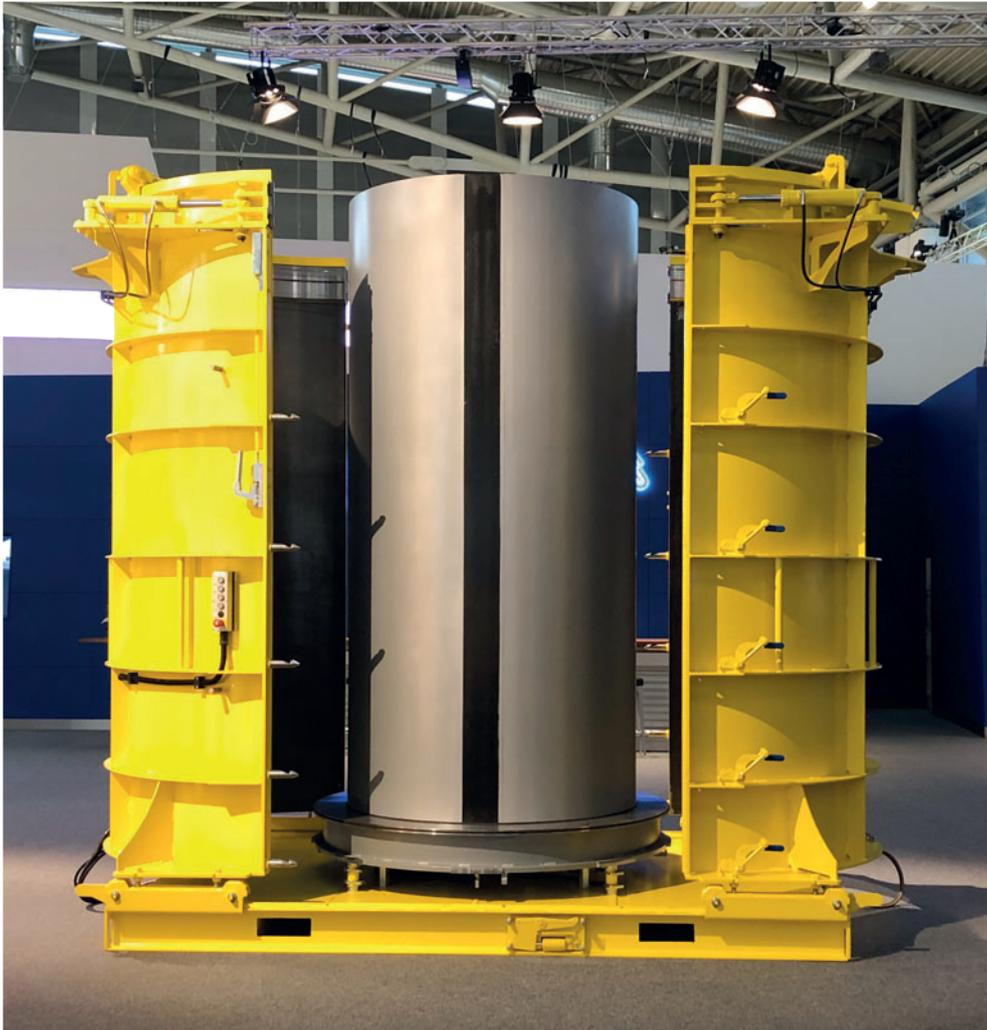
*Schlüsselbauer presentó un ejemplo del sistema de producción Perfect Forming Technology con el molde de núcleo reducible que no necesita mantenimiento y desencofrado que protege los extremos utilizado hace unos días para producir los ejemplares de tubo expuestos.*
