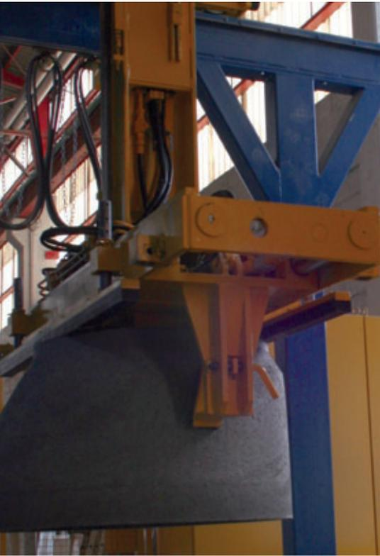
La grúa desplaza el elemento de pozo mediante manipuladora
