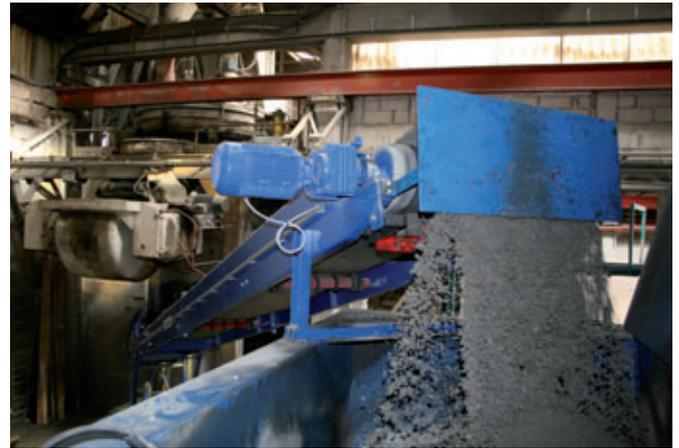
El abastecimiento de hormigón de la Magic 1501 se efectúa a través de las mezcladoras de la producción de hormigón existente de Frühwald
