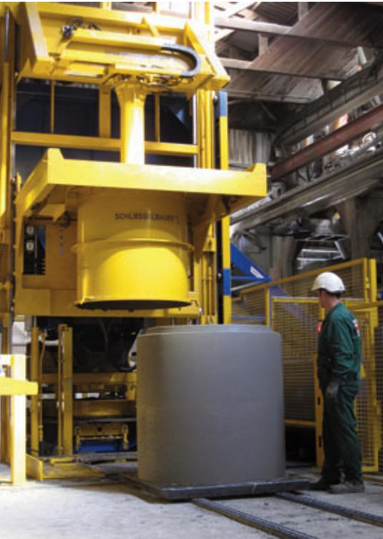
*La máquina está concebida para tamaños de producto hasta Ø 820 exterior en caso de producción doble y hasta Ø 1.800 mm exterior en producción simple*
