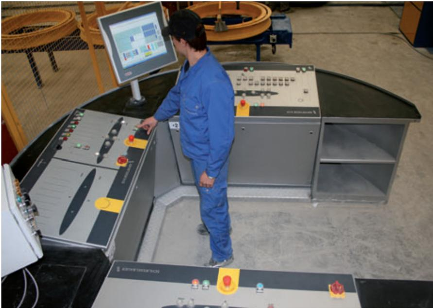
Debido al alto grado de automatización, tan sólo un operario maneja todas las fases de trabajo entre la mezcladora de hormigón y el transporte e los productos.
