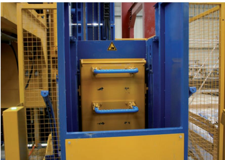
La unidad automática para la provisión de los moldes con estribos se llama Stepmaster.
