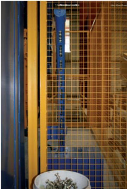
Una novedad en la fabricación de piezas prefabricadas de hormigón: Los cargadores de anclas de transporte con un depósito de aprox. 25 anclas por lado de montaje.
