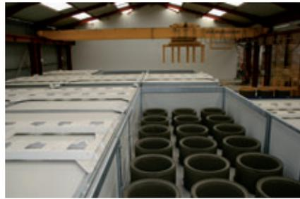
Los anillos de pozo fraguados justo antes de su transporte mediante el robot grúa.
