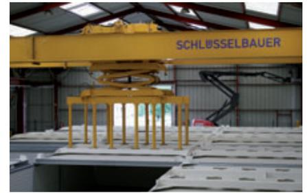
Mediante la rotación de las barras de sujeción puede realizarse un desplazamiento de los elementos de cubierta sin herramienta.
