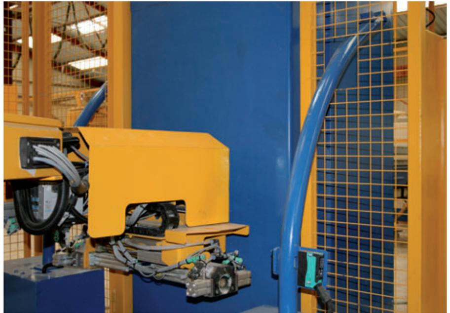
El robot de ensamble agarra de forma automática dos anclas posicionándolas en el molde.
