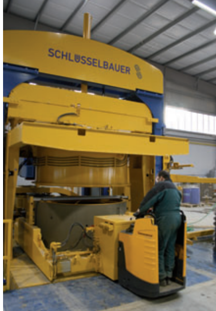
El manipulador de anillos protectores permite al operario colocar los anillos protectores en el producto recién fabricado sin esfuerzo y sin la ayuda de otro operario
