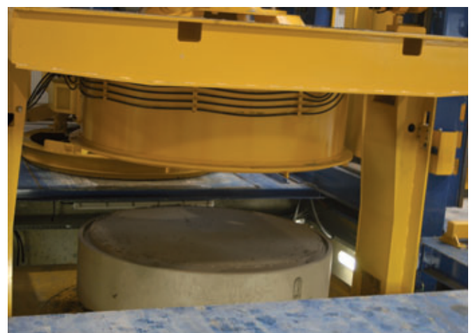
Transporte de evacuación de los anillos fuera de la máquina en tiempos de ciclo cortos
