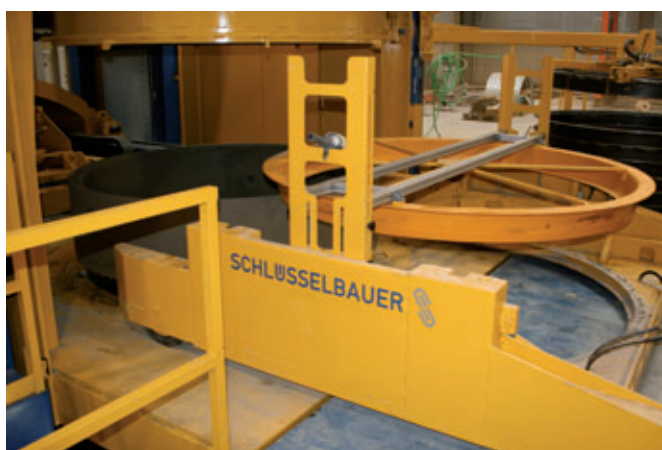
Un solo operario puede hacer funcionar todo el equipo de producción mediante desarrollos automatizados. Lo único que se realiza a mano es la instalación de los anillos de refuerzo.
