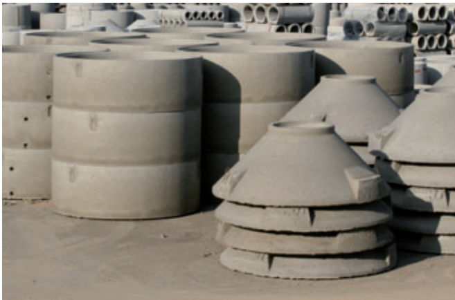
Productos de MAGIC2500 en almacén de Eurobeton Chvaletice: anillos de pozo, anillos filtrantes, conos
