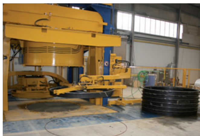
El dispositivo de colocación automática de manguitos es esencial para que esta instalación pueda funcionar con un solo operario
