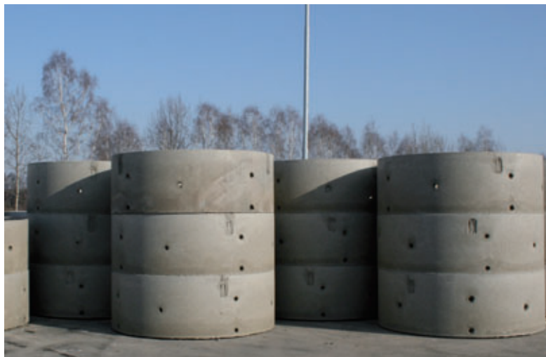
Anillos filtrantes en el almacén exterior
