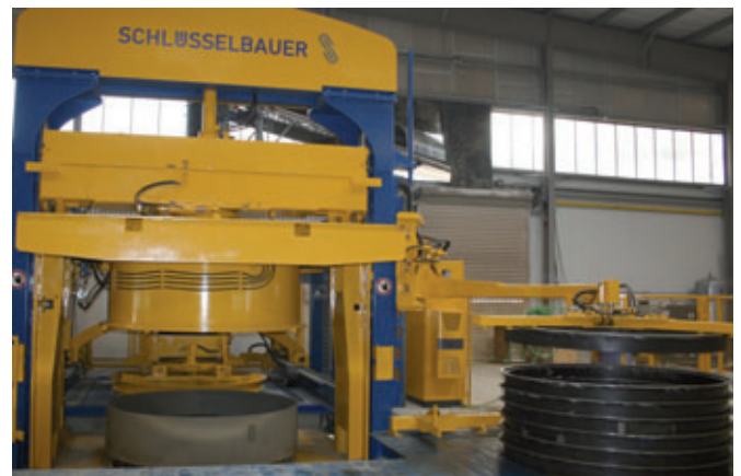
Equipo de producción Magic2500 para la fabricación de piezas prefabricadas de un diámetro exterior de hasta 2.700 mm
