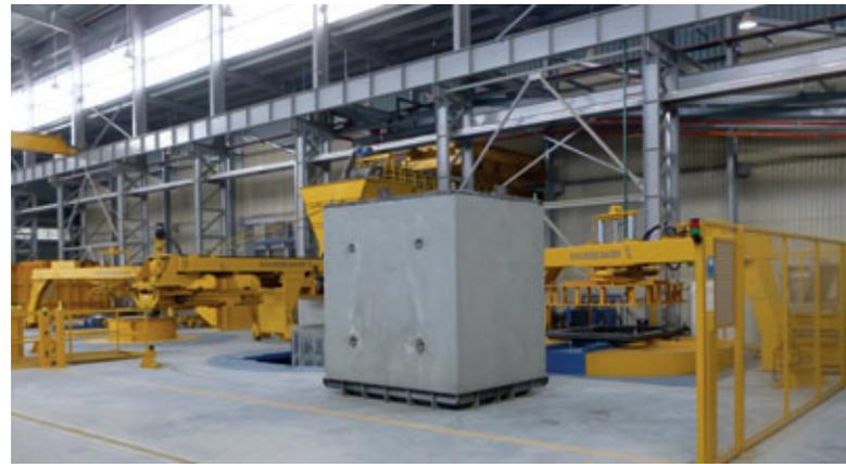
Gracias al uso de manguitos superiores de acero, la instalación tipo Exact XL permite acoplamientos con un acabado muy preciso, tanto en tubos como en componentes de construcción.
