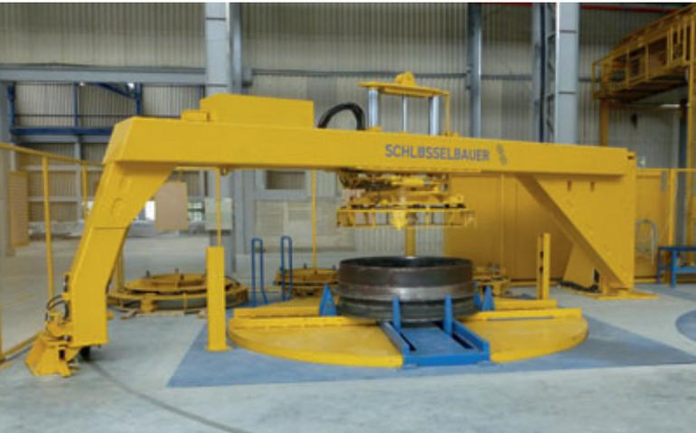
Los manguitos superiores se insertan automáticamente en la máquina antes del proceso de prensado y se mantienen en el producto durante todo el ciclo de fraguado.
