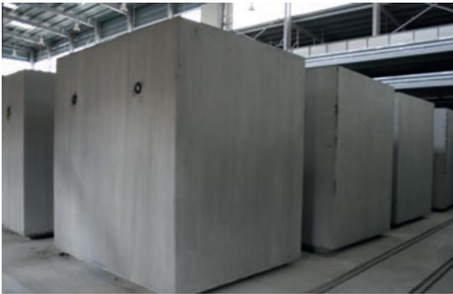
Componentes de construcción de gran formato de dimensiones 2.000 x 1.500, 2.000 x 2.000, 2.000 x 2.500 y 2.500 x 2.500 mm se producen en Amiantit Oman Concrete Products LLC en medidas industriales.
