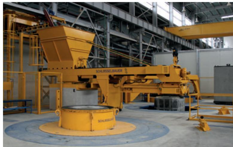
La planta de producción flexible Exact XL está lista para el siguiente paso de la fabricación de tubos.
