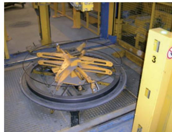
*Los manguitos no se transportan nunca manualmente para evitar posibles daños ocasionados por el transporte. Don Anger comenta: “Eso es esencial. Los daños en los manguitos influyen en seguida en el producto final, tanto en la estanqueidad, que deja de ser fiable, como en el encaje de los componentes entre sí.”*
