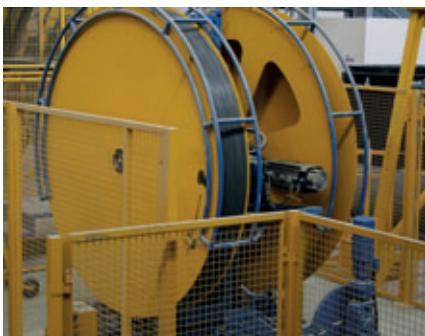
El cable de acero necesario para la pre-tensión se coloca igualmente en bobinas en la planta, donde se procesa con una velocidad de bobina de hasta 6 m/s.
