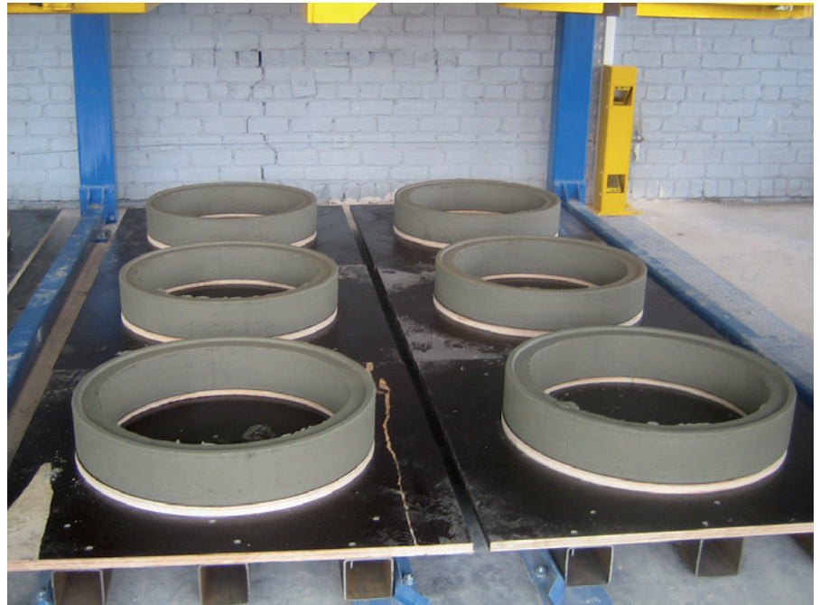
anillos machihembrados DN700 fabricados con la Ringmaster de la empresa JSC Gelgaudiskio Gelzbetonis
