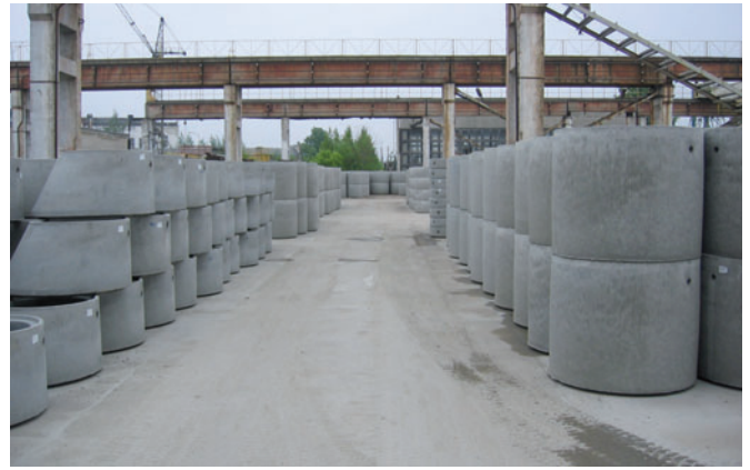
elementos modernos de pozos para su uso en obras civiles en Lituania. En la figura se muestran conos y anillos de pozo en Kauno Gelzbetonis.
