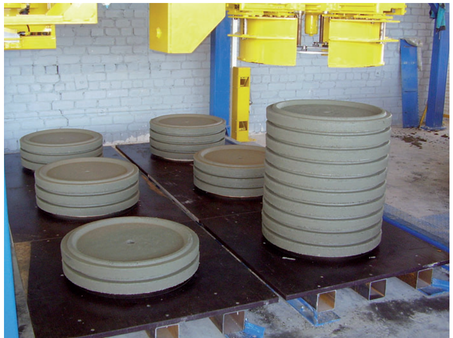
anillos machihembrados DN700 fabricados con la Ringmaster de la empresa JSC Gelgaudiskio Gelzbetonis
