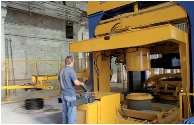
salida de un anillo de pozo del equipo Magic en la fábrica de hormigón Marijampolés Gelzbetonis.
