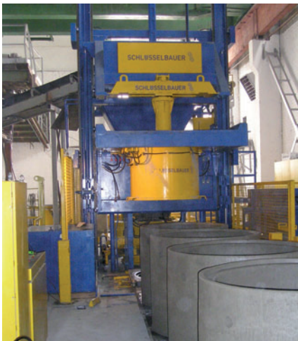
anillos machihembrados DN700 fabricados con la Ringmaster de la empresa JSC Gelgaudiskio Gelzbetonis
