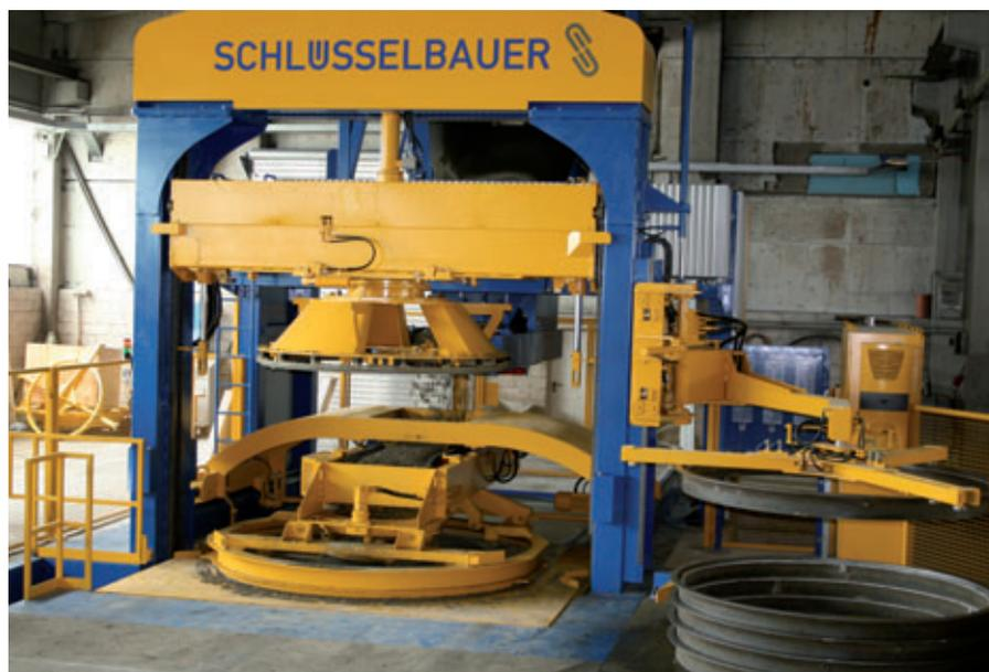
La planta de producción Magic2500 para la fabricación de piezas prefabricadas con un diámetro exterior de hasta 2.700 mm.
