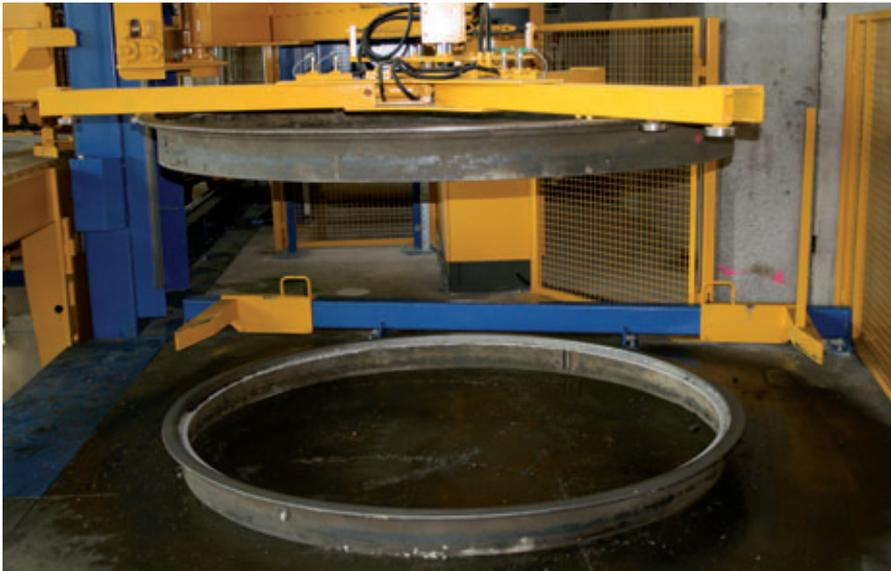
*El dispositivo automático de inserción de aros permite el manejo de toda la instalación por un solo hombre.*
