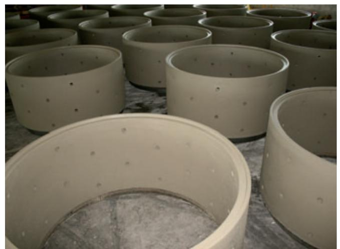
*Anillos de drenaje DN2500 en la zona de curado.*
