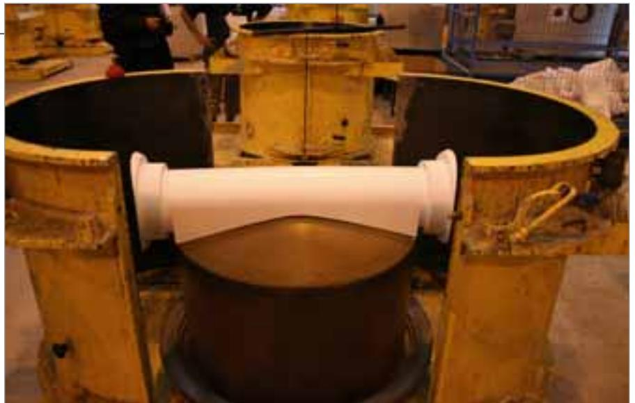
Los cuerpos de molde terminados se colocan en los moldes preparados para las bases de pozo.
