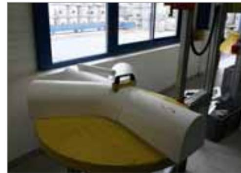
En la preparación para la producción de las bases de pozo, las piezas moldeadas son cortadas de icopor mediante alambre caliente, de tal forma que todas las curvas de las piezas individuales se ajustan perfectamente.
