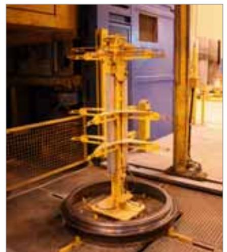
Antes de la producción de los anillos de pozo, la arandela base, el aro de armadura así como el ancla de transporte y posibles escalones son posicionados automáticamente.
