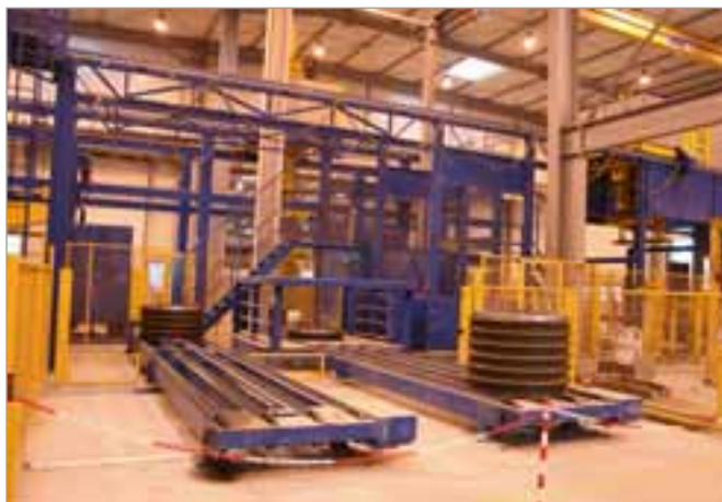
La planta dispone de un sistema de manejo de arandelas en automático.
