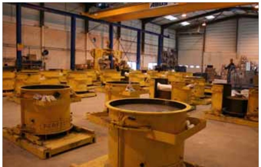
El hormigón auto aglomerante se transporta a través de una cinta al cubo de la grúa con cuya ayuda se hormigonan los moldes.
