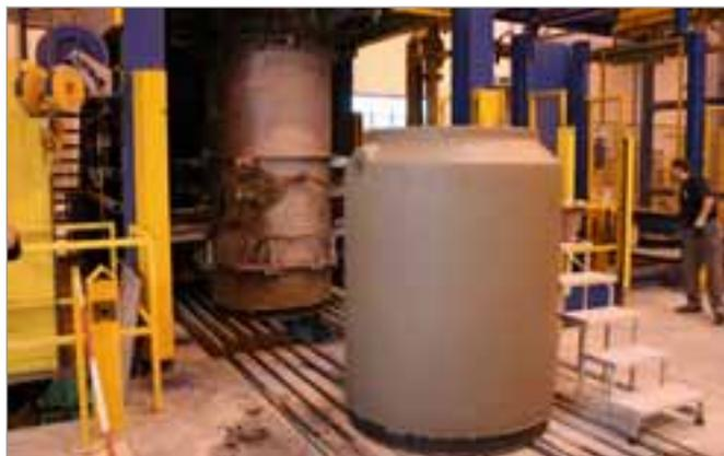
Justo después de la producción los componentes de pozo son desencofrados.
