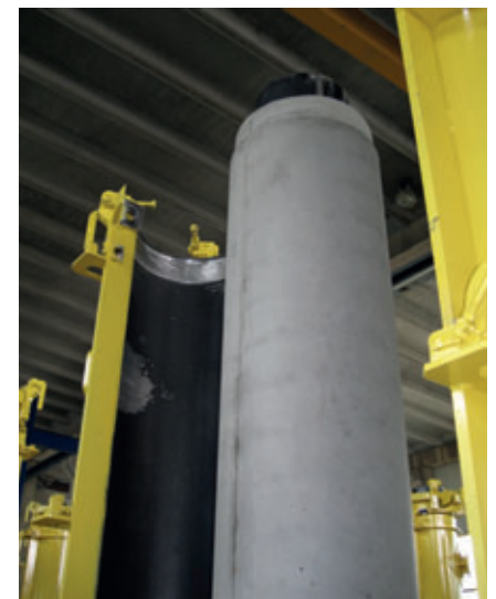
Los tubos de hormigón de colada se fabrican con hormigón fluido y, en consecuencia, con unas tolerancias extremadamente reducidas
