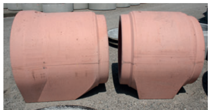
Los tubos con la longitud constructiva estándar de 3 m, las articulaciones y los elementos de ajuste se fabrican de la misma manera con endurecimiento en encofrado.
