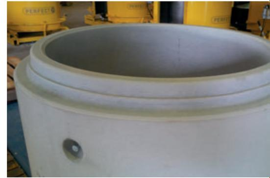
Los anclajes de transporte incorporados en la pared del pozo garantizan el manejo seguro de las bases de pozos hasta su colocación en la obra.
