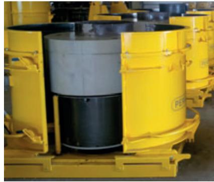
La altura constructiva de las piezas prefabricadas se puede adaptar fácilmente en los equipos de moldeo.
