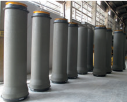
Los tubos de hormigón suelen permanecer un día laborable en la zona de curado.
