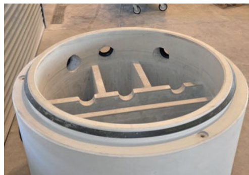
Con el sistema de producción Perfect no solo se pueden fabricar de forma rentable bases para pozos, sino también elementos especiales, como puntos de captación.
