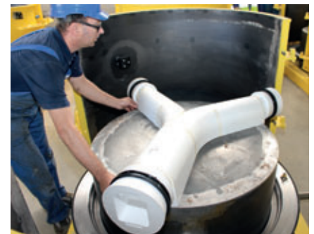
Colocación de un negativo de canaleta en un molde de acero
