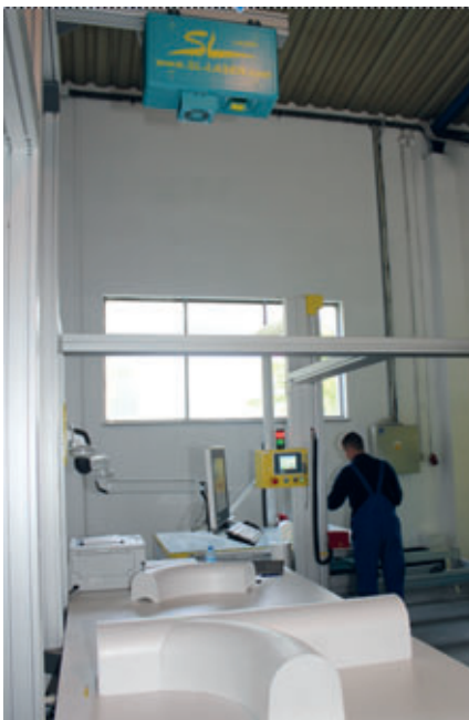
Del control del posicionamiento exacto de las diferentes piezas se encarga un láser situado sobre la mesa de trabajo, que indica continuamente todas las líneas de la base de pozos sobre la mesa
