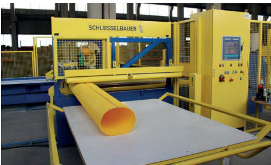
Las líneas de liner se sueldan de forma completamente automática para formar cilindros estancos.
