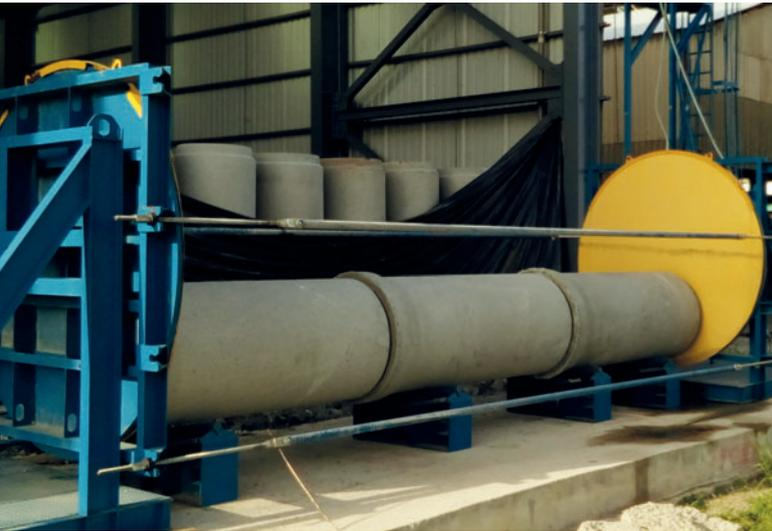
Los tubos de hormigón fabricados en los modelos de máquina Exact XL y Precise se comprueban con respecto a la estanqueidad al agua y la resistencia a la presión.
