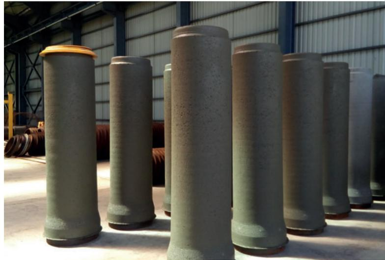
En Trans-Canal Centre, los tubos de hormigón recién desencofrados suelen permanecer un día de trabajo en la zona de curado.
