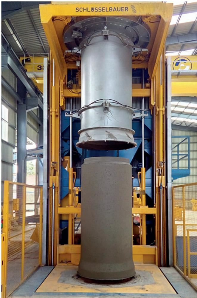
*Fabricación de un tubo de hormigón con manguitos en campana DN800 en la instalación Precise, suministrada por Schlüsselbauer Technology.*
