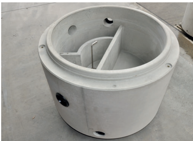
Arqueta de DN1200 fabricada de hormigón líquido con canal conformado individualmente y juntas integradas en el hormigón.
