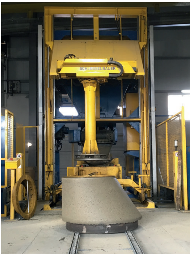
Instalación de producción Magic de Schlüsselbauer Technology
