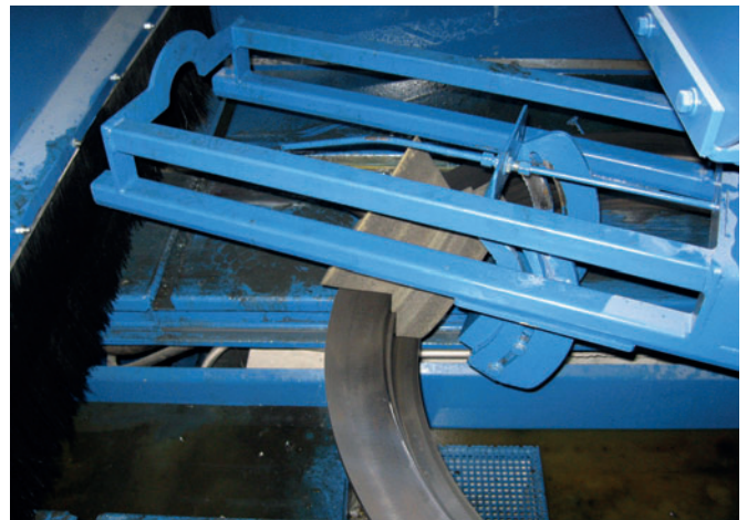
Engrase de manguitos con espuma y sin niebla de pulverización
