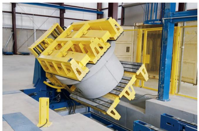
Für das Handling der Produkte mit Auftriebssicherung wurde eine automatische Wendestation eingebaut.
