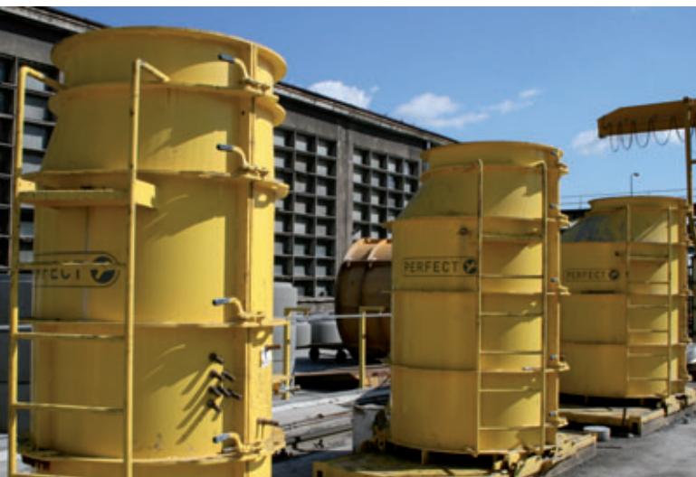
Die drei neuen Formen für bis zu 2.350 mm hohe Betonschachtkonen mit Nennweiten von 1.000, 1.200 und 1.500 mm
