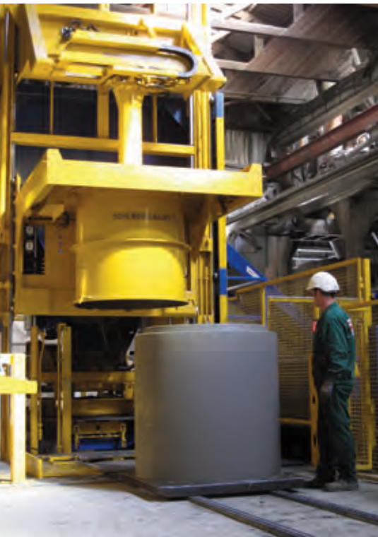
Die Magic ist ausgelegt auf Produktgrößen bis \varnothing 1.800 mm außen bei Höhen bis 1.500 mm
