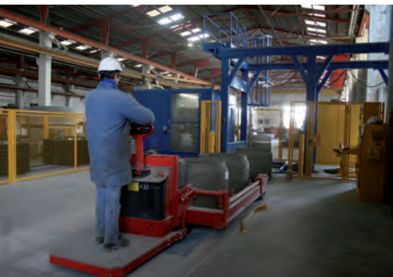
Die ausgehärteten Produkte der Vortagesproduktion werden mit dem Abfuhrwagen in die Verladestation befördert.
