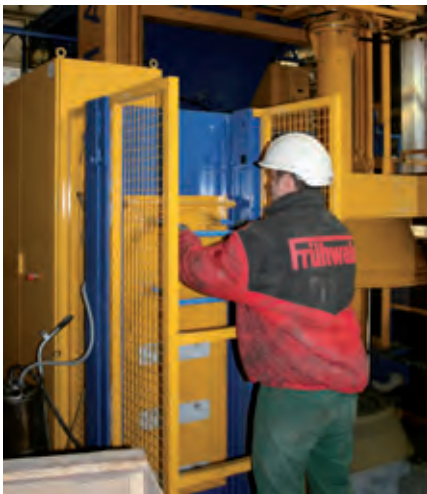
Einlegen der Steighilfen in den Stepmaster
