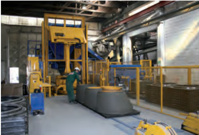
Magic 1501, rechts im Bild das Muffenmagazin vor der Einölstation
