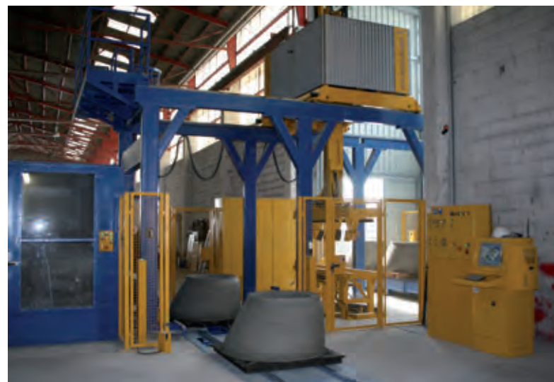
Die ausgehärteten Produkte der Vortagesproduktion werden mit dem Abfuhrwagen in die Verladestation befördert.
