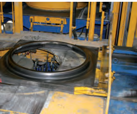
Automatischer Einschub der Muffe
