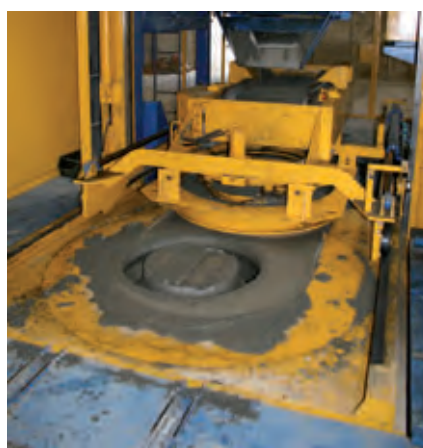
Befüllung und Verdichtung
