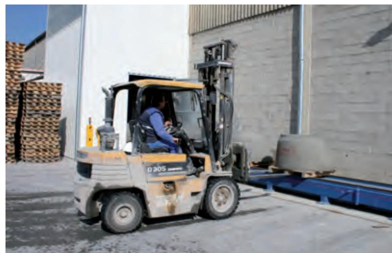
Die Betonfertigteile werden mittels Gabelstapler zu ihren vorläufigen Bestimmungsorten im Außenlager gebracht
