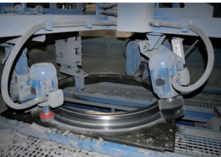
Cleanmaster – vollautomatische Muffenreinigung
