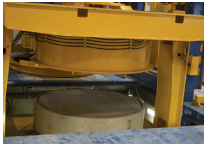
Ausfahren der Ringe aus der Maschine in kurzen Taktzeiten
