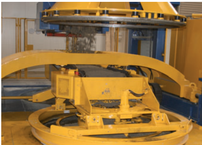
Die gesamte Betonversorgung der Magic2500 wurde neu errichtet, im Bild die rasche Einbringung des Betons in der Maschine
