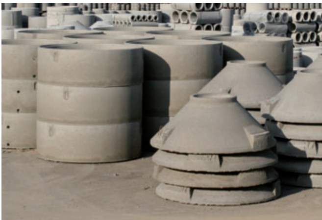
Die Produkte der Magic2500 am Lager von Eurobeton Chvaletice: Schachtringe, Sickerringe, Kone
