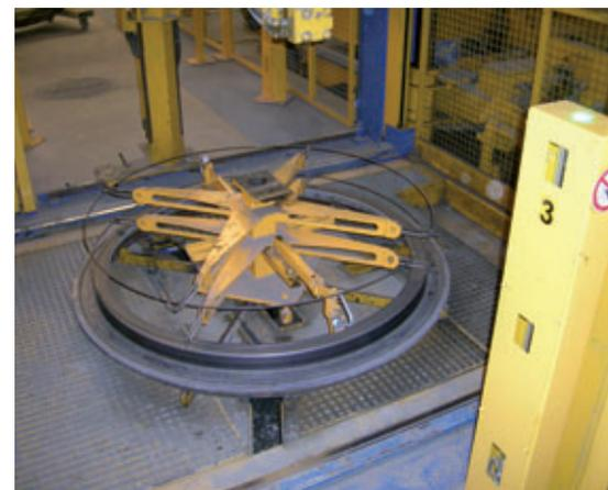
Muffen werden niemals manuell transportiert und dementsprechend Transportschäden vermieden. Don Anger erklärt: „Das ist wesentlich. Beschädigungen an den Muffen beeinflussen sofort das Endprodukt und damit die zuverlässige Dichtheit und die Passung der Bauteile zueinander.“
