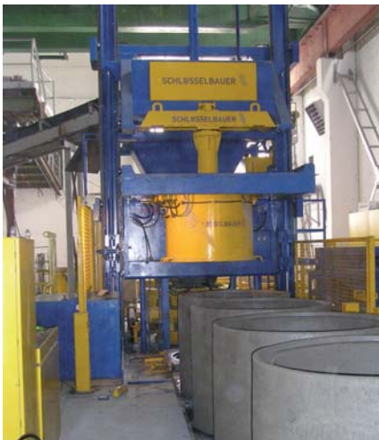
Falzringe DN700 aus der Ringmaster-Fertigung des Unternehmens JSC Gelgaudiskio Gelzbetonis
