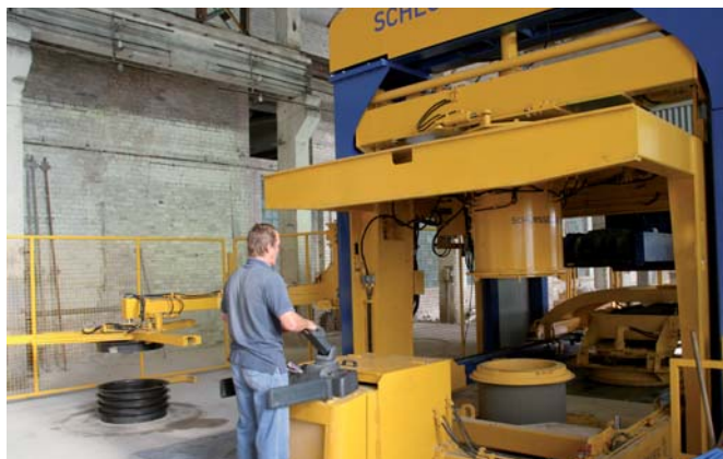
Ausfahren eines Schachtrings aus der Magic-Anlage im Betonwerk Marijampolés Gelzbetonis
