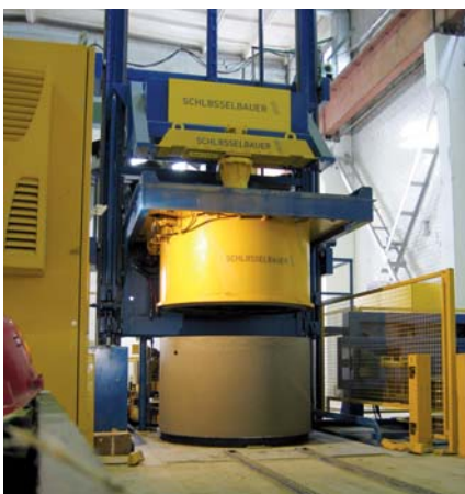
Deckel-Fertigung und Handling mittels Ringmaster-Stapel-Automaten
