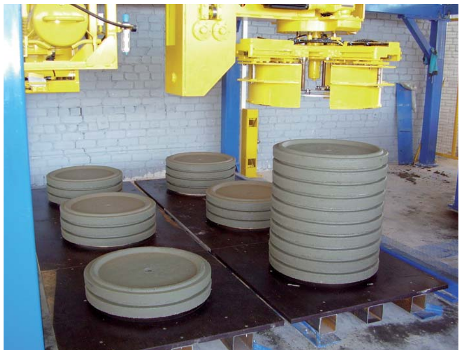
Deckel-Fertigung und Handling mittels Ringmaster-Stapel-Automaten
