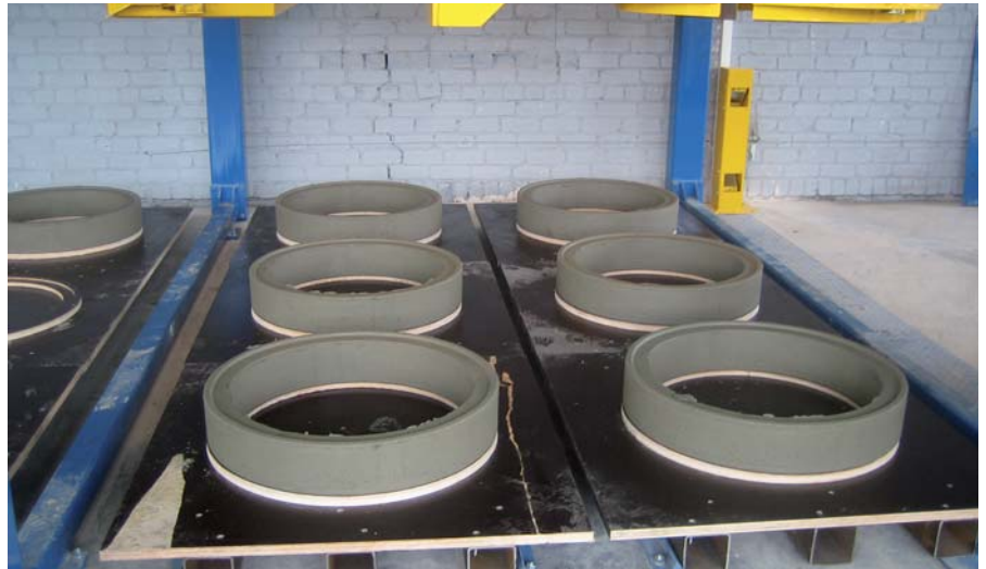
Falzringe DN700 aus der Ringmaster-Fertigung des Unternehmens JSC Gelgaudiskio Gelzbetonis
