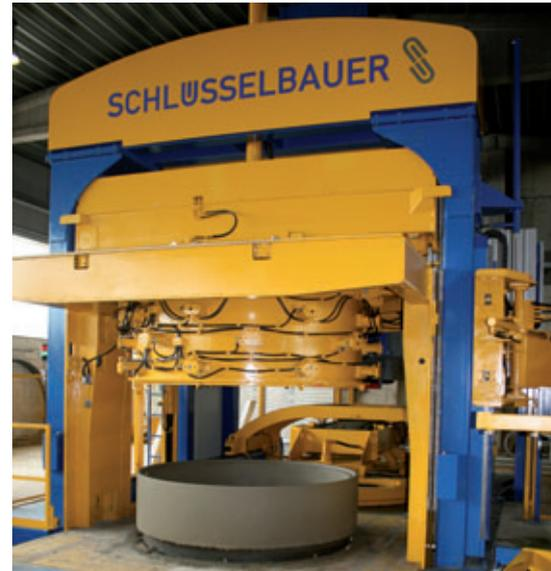
Großformatige Produkte in unterschiedlichen Bauhöhen werden von der Magic 2500 in sehr kurzen Taktzeiten gefertigt
