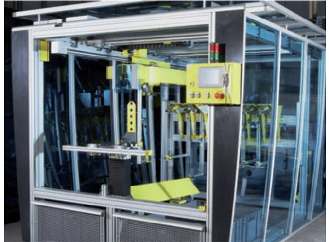
Für die Herstellung der EPS-Negativ-Gerinneformen für die Perfect-Fertigung werden die seit mehreren Jahren im Produktionsalltag bewährten Heißdrahtsägen eingesetzt
