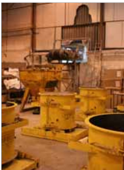
Über ein Förderband wird selbstverdichtender Beton in einen Krankübel transportiert, mit dessen Hilfe die Formen ausbetoniert werden.
