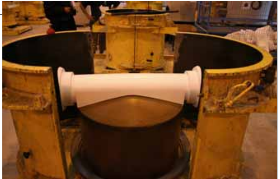
Die fertigen Formkörper werden in die vorbereiteten Formen für die Schachtunterteile gelegt.
