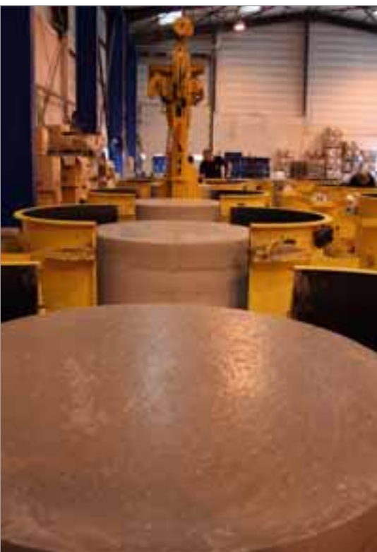
Nach einem Tag werden die Schachtunterteile, die am Vortag produziert wurden, wieder ausgeschalt.
