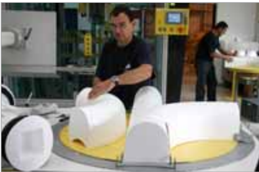
Bei der Vorbereitung zur Produktion der Schachtunterteile werden mittels Heißdraht die Formstücke aus Styropor zurechtgeschnitten, so dass sich alle Krümmungen perfekt aneinanderschmiegen, wenn die Einzelteile zusammengesetzt werden.
