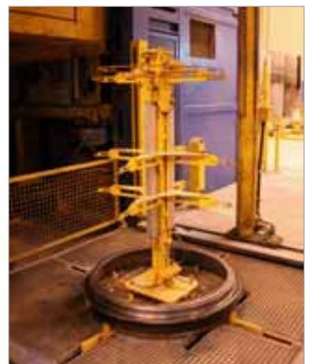
Vor der Produktion der Schachtringe werden die Untermuffe, der Bewehrungsring, sowie die Transportanker und etwaige Steigbügel automatisch positioniert.
