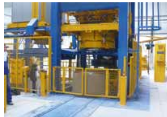
Die Exact 1500 im Einsatz – vollautomatische Fertigung von Schachtringen mit Ober- und Untermuffen
