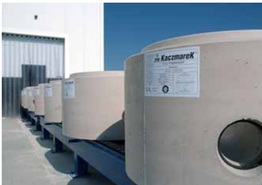
Die Beschriftung jedes individuellen Schachtunterteils unterstützt die gesamte Logistik – bis hin zum Einbau auf der Baustelle
