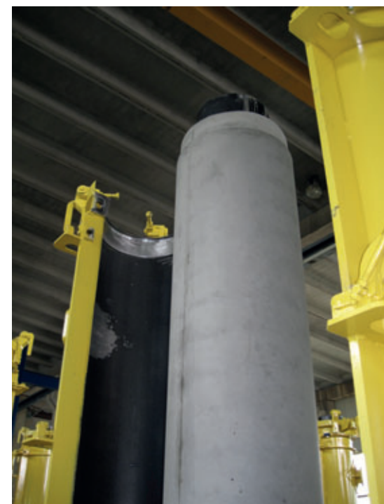
Betonrohre aus Fließbeton werden schalungserhärtet und damit mit äußerst geringen Toleranzen hergestellt.
