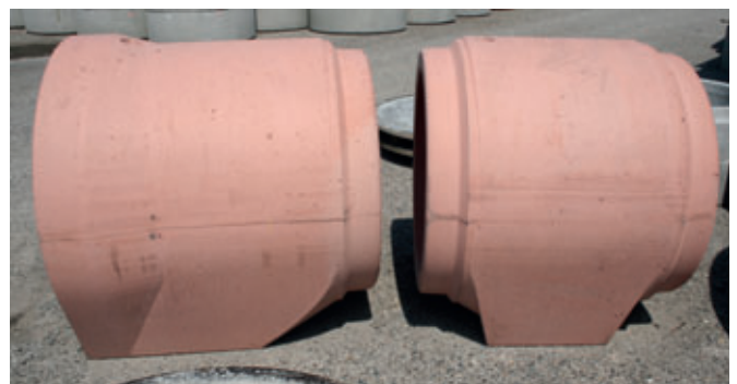
Rohre der Standardbaulänge 3 m und Gelenk- und Pass-Stücke werden gleichermaßen schalungserhärtet gefertigt.
