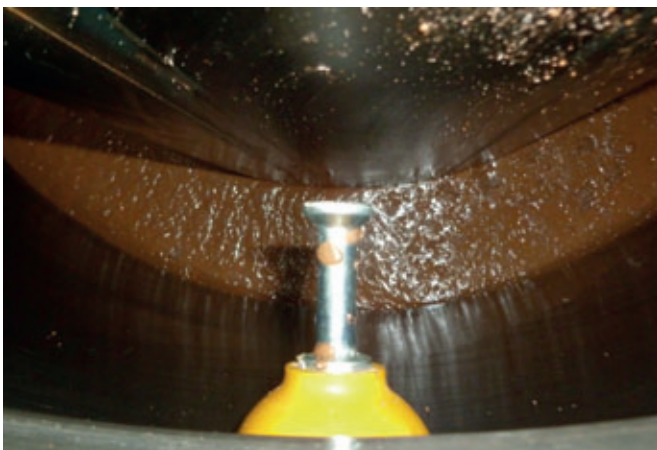
Durch das Befüllen der Formen mit fließfähigem Beton werden Einbauteile wie etwa Transportanker vollständig von Beton umschlossen.
