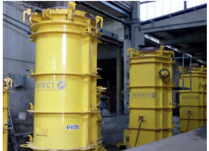
Zur Herstellung der Rohre in den Nennweiten DN700 bis DN1200 wurden bei Beton Müller mehrere Gießformen in einem abgesenkten Hallenbereich in Betrieb genommen.
