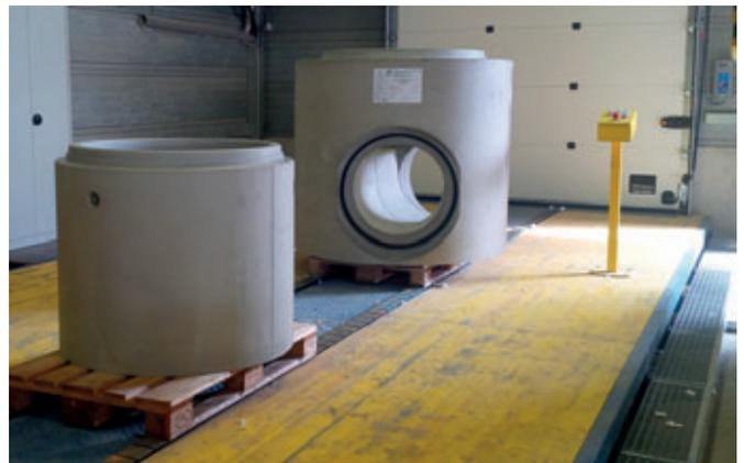
Erste Produkte mit integrierten Dichtungen verlassen – in makelloser Qualität – die Schachtfertigung.
