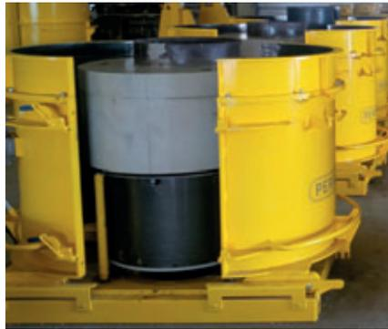
Die Bauhöhe der Fertigteile kann in den Formausrüstungen einfach angepasst werden.
