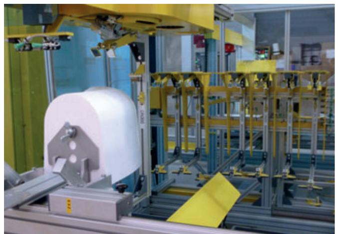
Mittels Heißdrahtsägen werden aus EPS-Formteilen passgenau die Negative der benötigten Gerinnebestandteile geschnitten.
