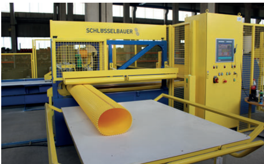
Vollautomatisch werden Linerbahnen zu dichten Zylindern verschweißt.
