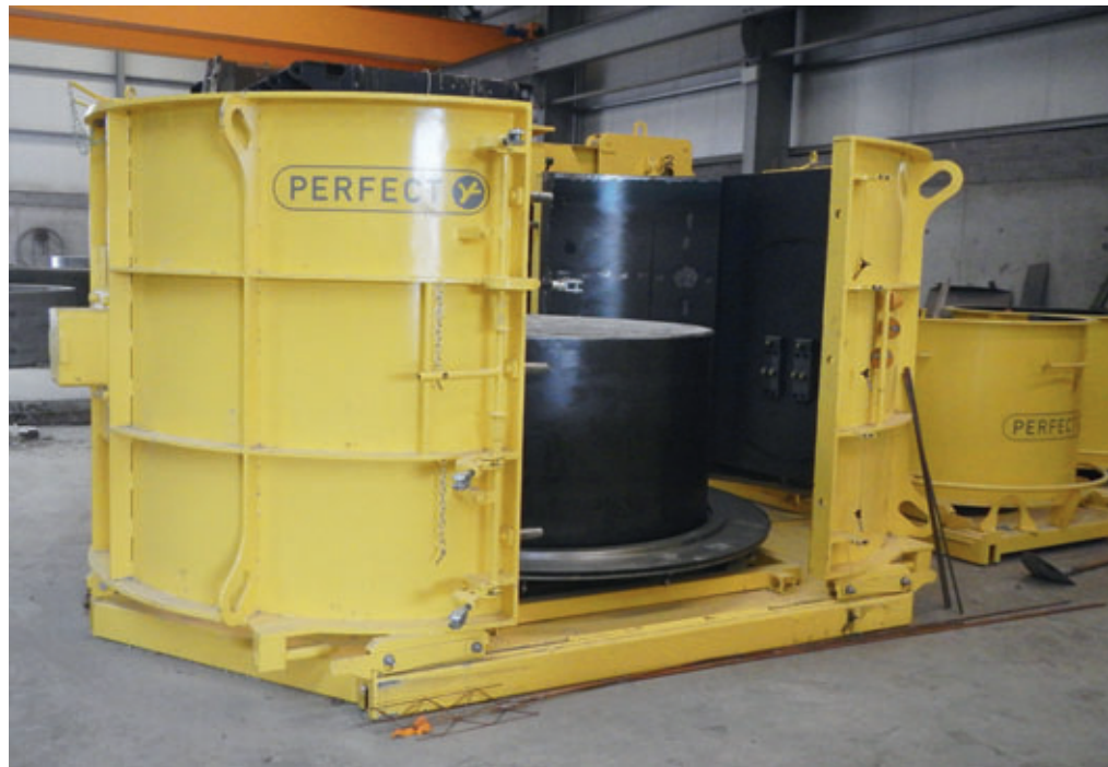
Mit einem Durchmesser von bis zu 1800 mm fertigt Tracey Concrete maßgefertigte Betonschachtunterteile unter Einsatz von EPS-Formteilen.
