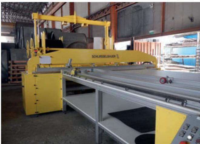
Ablängen und vollautomatisches Schweißen der Perfect Liner-Folie entsprechend dem gewünschten Rohrdurchmesser
