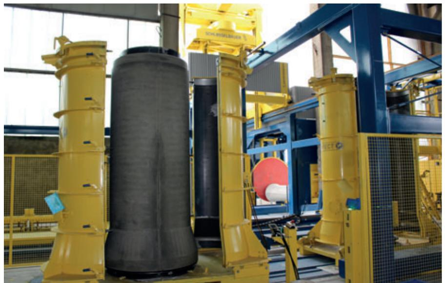
Ein Roboter mit einem universellen Greifer für alle Rohrdurchmesser umfasst das Rohr und hebt es vorsichtig vom Formkern.
