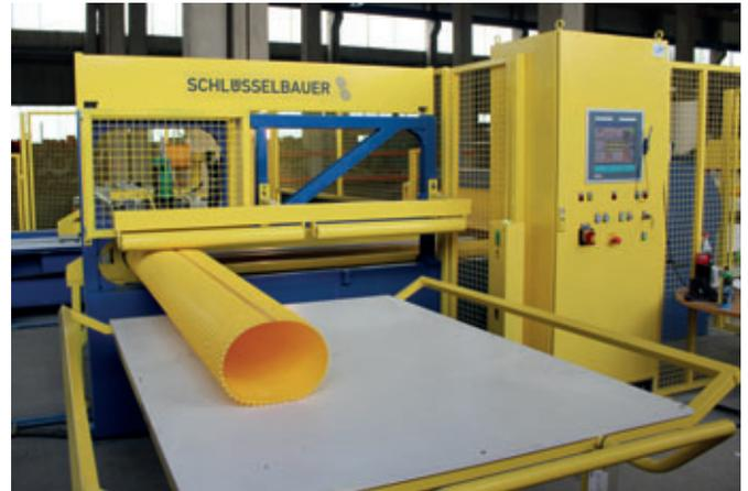
Mittels Schweißroboter wird eine Schweißnaht aus PE-Draht aufgebracht und die beiden Enden der Folie kraftschlüssig miteinander verbunden. Nach dem Verschweißen ist aus der Folie ein Liner-Zylinder geworden.
