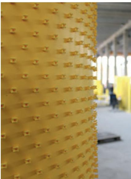
Der spätere feste Verbund des Liners mit dem umgebenden Betonrohr wird durch zahlreiche kleine Anker auf der Rückseite des Liners erreicht.
