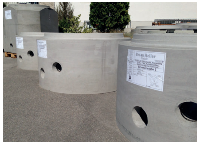
Betonbrunnenstuben mit werkseitig integrierten Dichtungen und Überlaufschächte von Beton Heller kurz vor der Auslieferung auf die Baustelle
