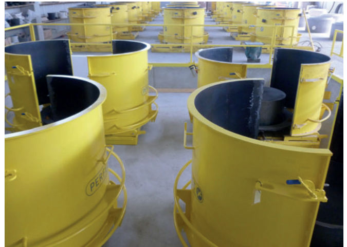
Bedienerfreundliche Stahlformen zur Fertigung von schalungserhärteten Betonfertigteilen mit individuell angepasster Gerinnekonfiguration
