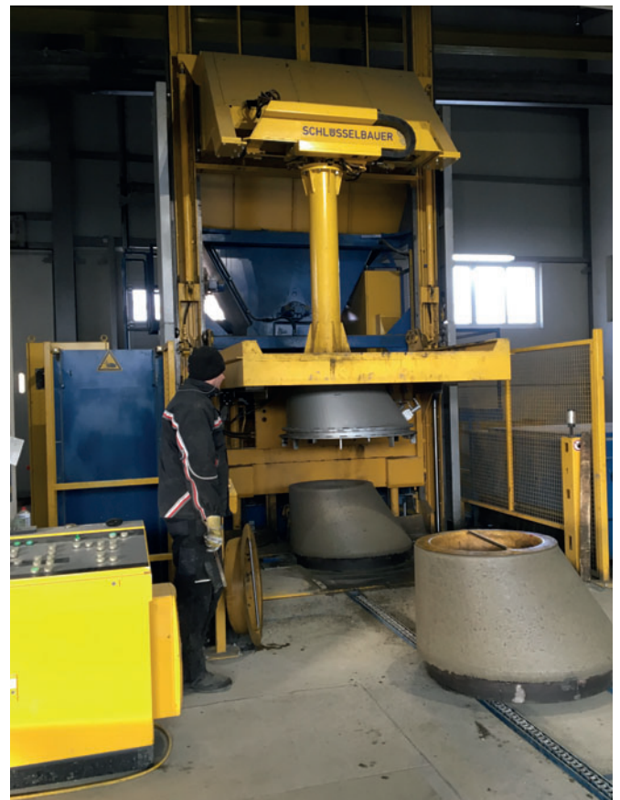
Entschalen eines fertigen Produkts
